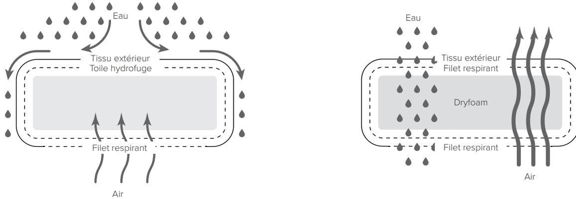
les rembourrages imperméables à l'eau disposent d'une toile en polypropylène laminé hydrofuge, ce qui empêche l'eau d'y pénétrer. Le fil utilisé pour coudre les coutures, gonfle quand il est mouillé, empêchant l'eau de pénétrer à travers les coutures. En plus, les coutures sont protégées à l'intérieur avec une couverture supplémentaire. Si néanmoins de l'eau rentre, le matériau est respirant : il permet à l'humidité de s'évacuer afin d'éviter le risque de moisissure.
