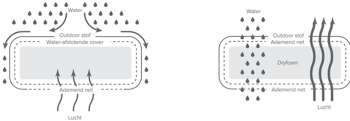
**Waterafstotende kussens** hebben een hoes rond de vulling in gelamineerd, waterafstotend polypropyleen waardoor water niet in de vulling kan binnendringen. De draad die gebruikt wordt om de naden te stikken, zwelt op als hij vochtig wordt, waardoor water ook niet langs de naden kan binnenkomen. Bovendien worden de naden aan de binnenzijde ook nog beschermd met een extra hoesje. Indien water toch nog zou binnensijpelen, kan het vocht eruit omdat de vulling ventilerend is.
